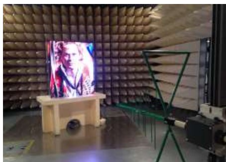
Essai en cage anéchoïque Exemple de mesures d'investigations CEM
