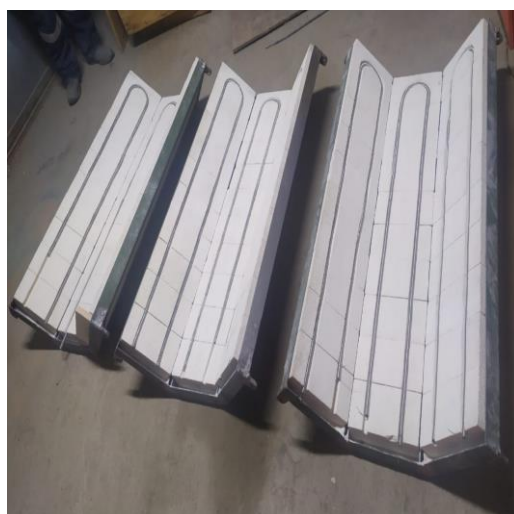
Fabrication des radiateurs du convoyeur
