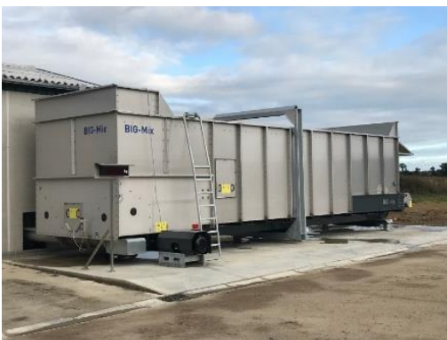
Trémie BIG MIX de 80 m3 à fond mouvant couplée à un système de broyage MULTIMix 40m3/h
